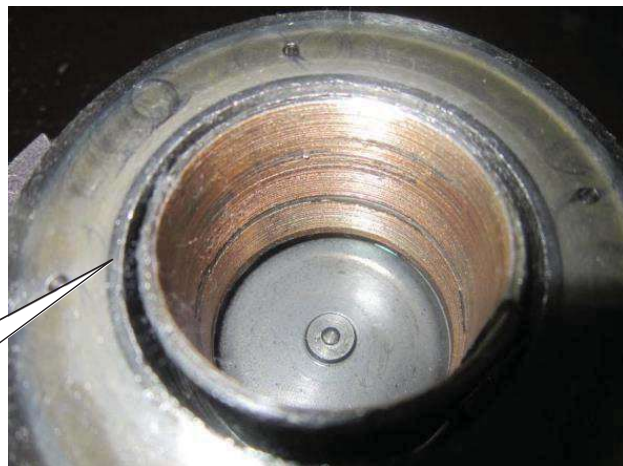
A placa scroll está desgastada.
