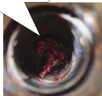
Filtro bloqueado por impurezas, a sucção do compressor será comprometida.
